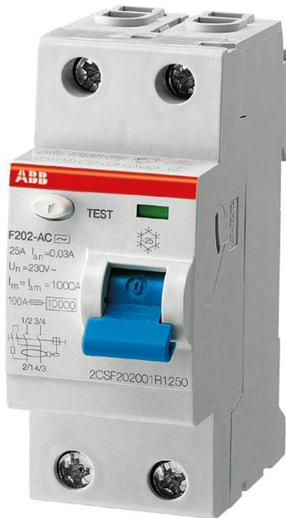
È detto differenziale, perché basa il suo funzionamento sulla rilevazione dell'eventuale differenza di correnti elettriche rilevata in ingresso e in uscita al sistema elettrico in caso di dispersione.
