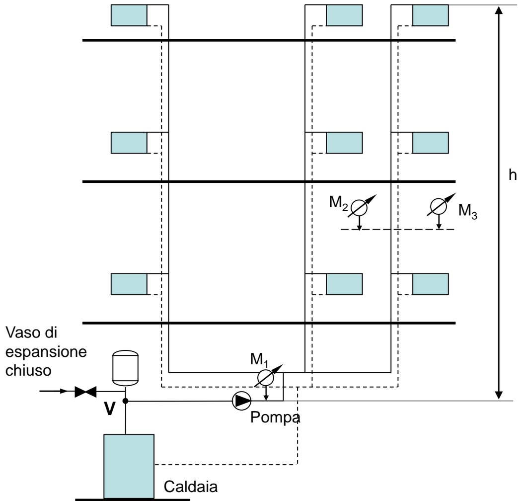
Nel punto in cui è inserito il vaso **(V)**, la **pressione** è uguale a quella **del gas** (pressione di carica) aumentata o diminuita della **pressione idrostatica** dovuta alla colonna di liquido sovrastante o sottostante
