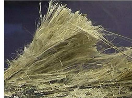
Amianto o asbesto è un materiale in fibre incombustibili (resiste fino ad oltre 500°C), resistente ad agenti chimici e biologici, suscettibile a tessitura, stabile meccanicamente.
