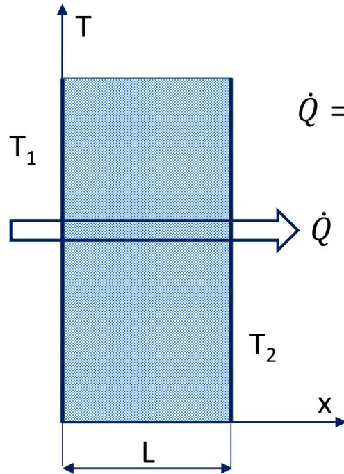
$$\dot{Q} = -\lambda \cdot A \cdot \frac{dT}{dx} \Rightarrow \dot{Q} \cdot dx = -\lambda \cdot A \cdot dT \Rightarrow \int_0^L \dot{Q} \cdot dx = - \int_{T_1}^{T_2} \lambda \cdot A \cdot dT$$
