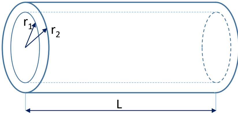
Tubo a **sezione circolare** delimitato da **due superfici isoterme** a temperature, rispettivamente,  $T_1$  e  $T_2$
