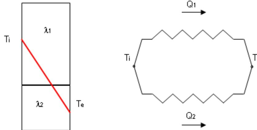
**Metodo dell'analogia elettrica:** corrispondenza tra fenomeno termico e fenomeno elettrico in un circuito di **due resistenze elettriche in parallelo**
