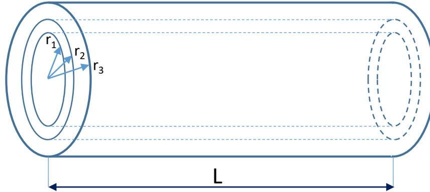
**Più strati cilindrici** disposti in modo **coassiale** l'uno sull'altro (es. tubi di un impianto di riscaldamento con uno strato di isolante o cavo elettrico rivestito da guaina isolante).
