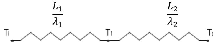
**Metodo dell'analogia elettrica:** corrispondenza tra fenomeno termico e fenomeno elettrico in un circuito di due resistenze elettriche in serie
