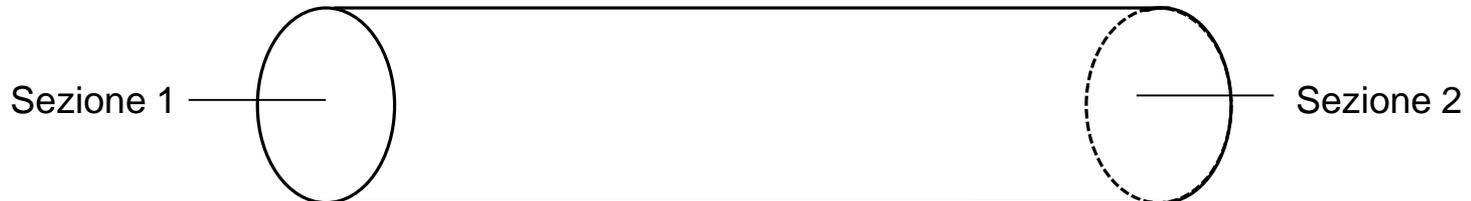
L'equazione scritta mette in evidenza che il **calore scambiato** dal sistema (fluido) con l'esterno equivale alla somma delle **variazioni di entalpia**, di **energia potenziale**, di **energia cinetica** e di una certa quantità di **lavoro tecnico utile**, ma una parte viene perso per **fenomeni dissipativi (R)** che sempre hanno luogo in una tubazione.
