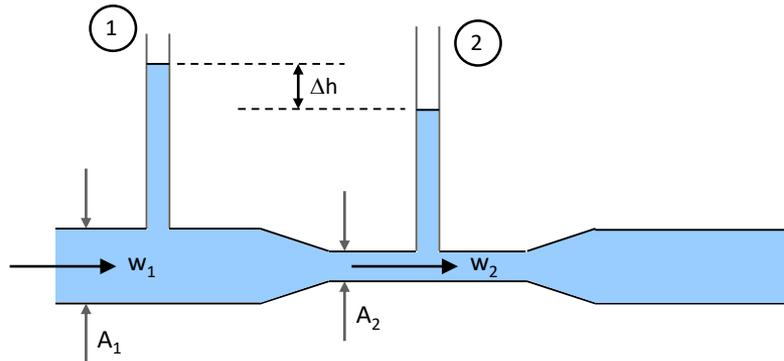
All'interno del tubo viene praticata una riduzione di sezione per un breve tratto. Due **manometri (1 e 2)** sono posizionati in modo da misurare la **pressione statica** del fluido in corrispondenza, rispettivamente, del valore massimo e minimo della sezione.
